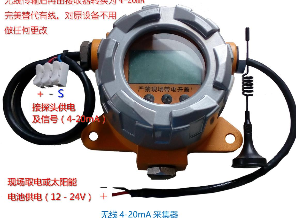
利用无线 4-20mA 采集器将现场变送器的 4 - 20mA 信号采集并转成无线信号发送，无线接收转换器收到无线信号后，将信号再转成 4 - 20mA 信号，提供给仪表显示控制。
